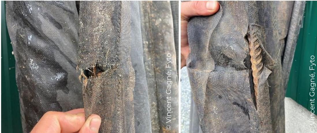
Figure 50. Exemple de bris sur les toiles.
