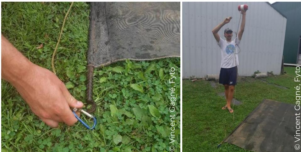
Figure 25. Bouée accrochée à l'extrémité d'une toile.
