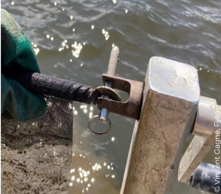
Les rondelles de métal sur les tiges de métal aux extrémités des toiles servent également à la fixer à la manivelle pour faciliter l'enroulement.
