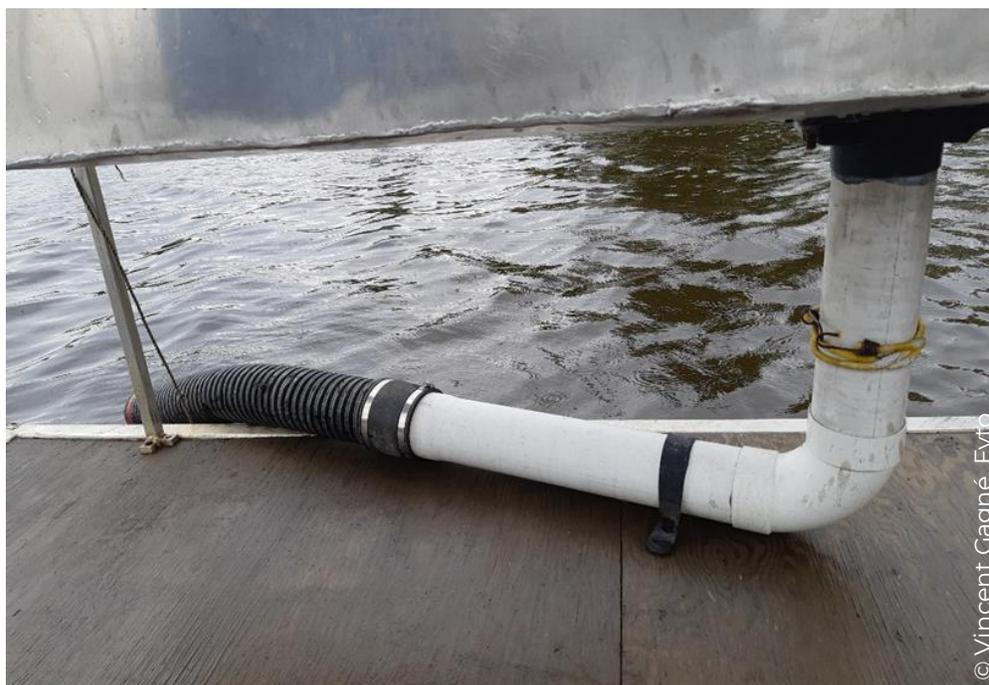
Figure 43. Rejet d'eau à l'arrière du ponton.
